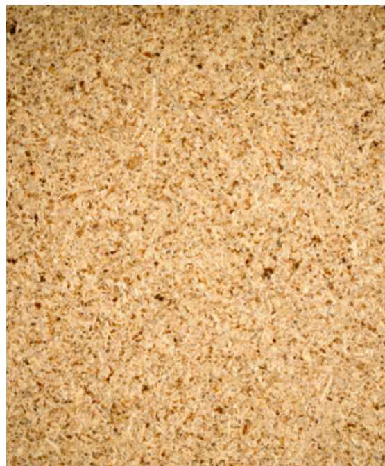
Tabiquería, sub. bases para pisos y entrepisos
